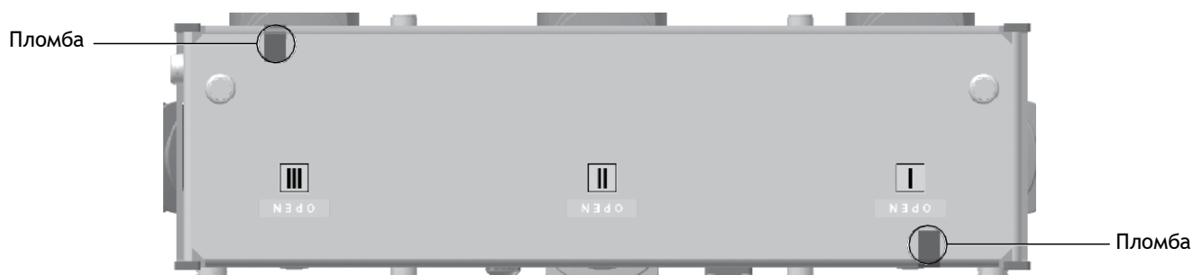
Рис. 3.18. Места пломбирования коммутационного модуля
