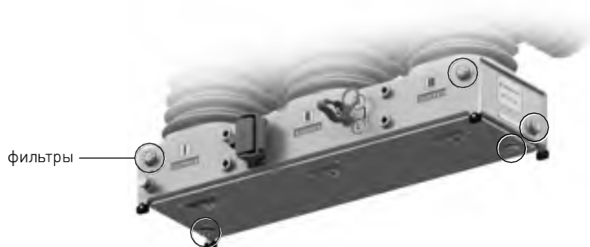
Рис. 3.3. Расположение дренажных фильтров
