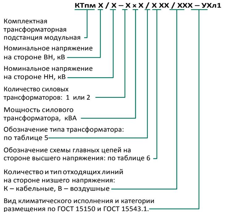
Пример записи обозначения тупиковой подстанции напряжением 35/6 кВ с двумя сухими трансформаторами мощностью 4000 кВА, схемой главных цепей 5Н по стороне 35 кВ, с восемнадцатью отходящими линиями (десять воздушных и восемь кабельных) по стороне 6 кВ:
