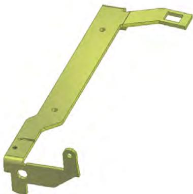
Рис.4.1. Рычаг блокировки
