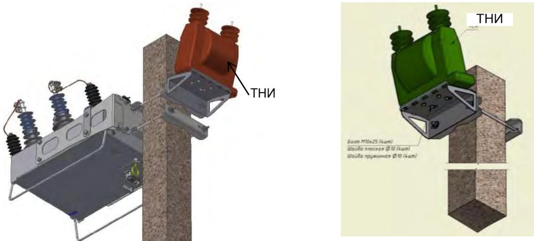
Рис. 7.23. Открутить болтовые соединения
