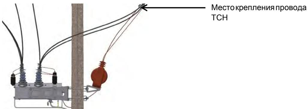
Рис. 7.17. Отсоединение высоковольтных цепей ТСН
