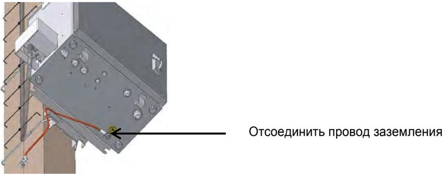
Рис. 7.15. Отсоединение провода заземления
