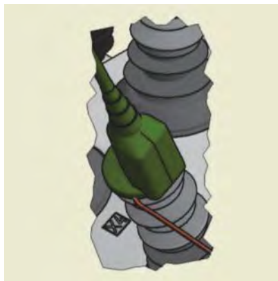
Рис. 7.5. Поднятие силиконового колпачка
