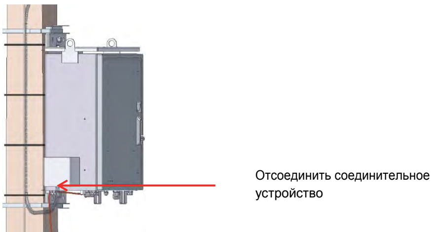
Рис. 7.10. Отсоединение соединительного устройства от шкафа управления
