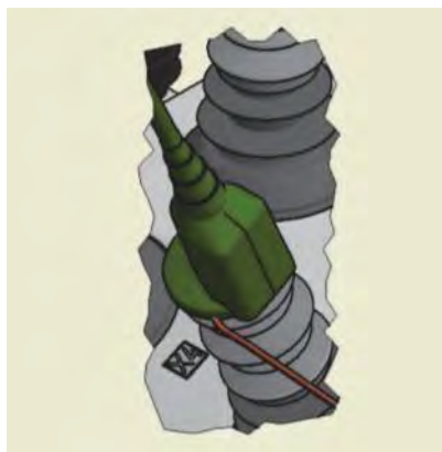
Рис. 7.20. Поднятие силиконового колпачка
