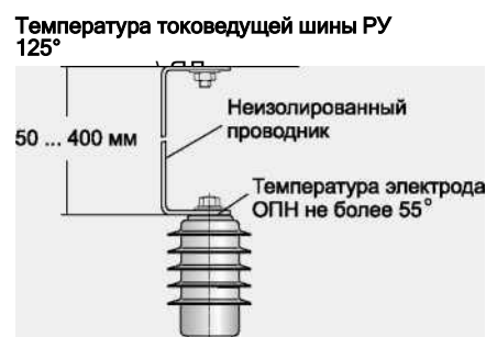
Рис. 10. Присоединение ОПН/TEL к токоведущим шинам.
