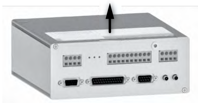
Рис. 37. Демонтаж модуля управления
