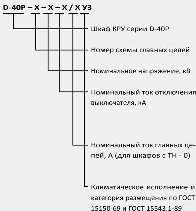
Пример записи обозначения шкафа КРУ серии D-40P со схемой главных цепей № 11, на номинальное напряжение 35 кВ, номинальным током отключения выключателя 25 кА и номинальным током главных цепей 1250 А: D-40P-11-35-25/1250УЗ.
