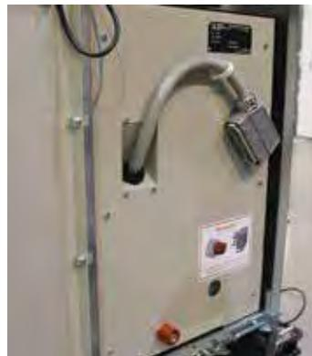
Рис. 2.21. Перевод КВЭ в разобранное положение
