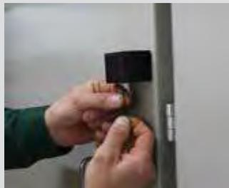
Рис. 2.35. Снятие защитного корпуса
