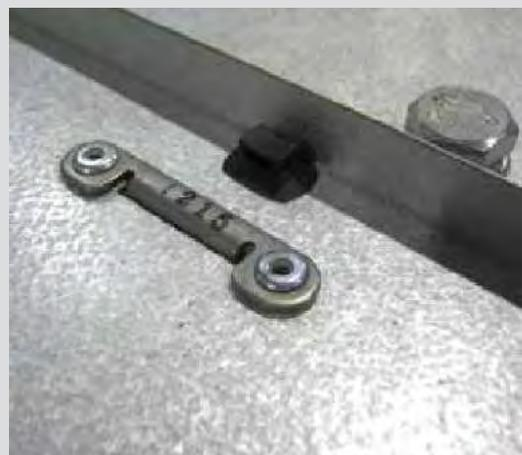
Рис.1.49. Пластиковый фиксатор клапана сброса давления
