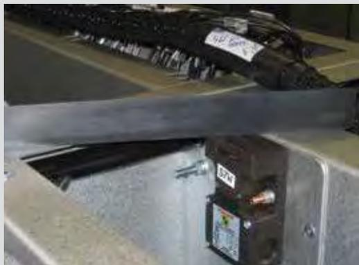
Рис. 3.1. Регулировка концевого выключателя
