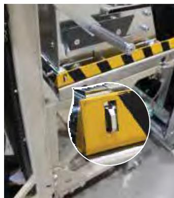
Рис. 2.25. Фиксация КВЭ на инвентарной тележке
