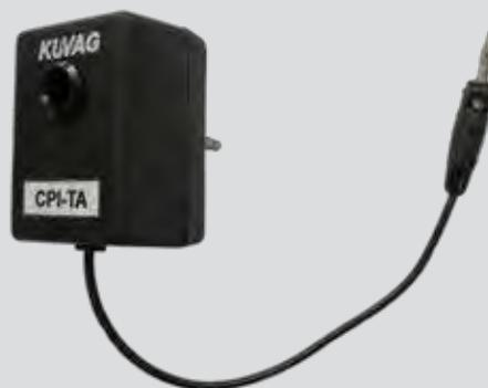
Рис. 1.26. Тестовый контроллер CPI-TA
