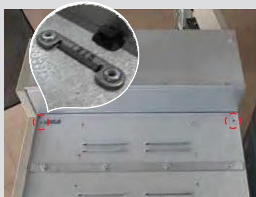
Рис. 3.2. Места установки фиксаторов
