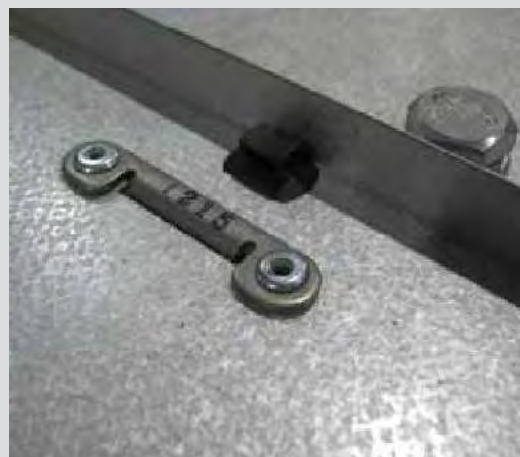
Рис.1.53. Пластиковый фиксатор клапана сброса давления
