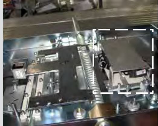
Рис. 1.33. Концевые выключатели контрольного положения КВЭ
