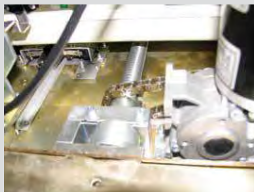
Рис. 2.29. Цепная передача привода
