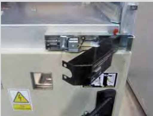
Рис. 2.32. Организация доступа к механизму электромагнитной блокировки Y81
