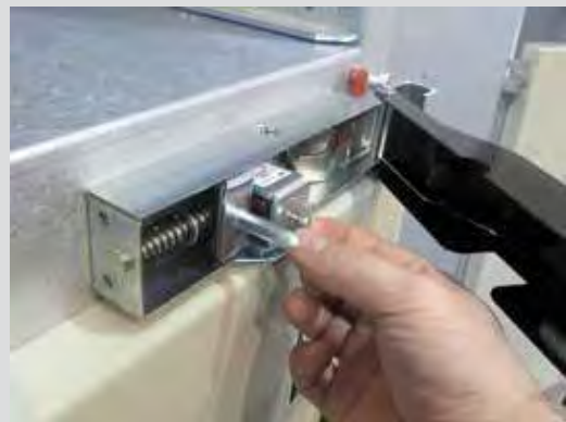
Рис. 2.33. Порядок деактивация блокировки Y81 (шаг 1)
