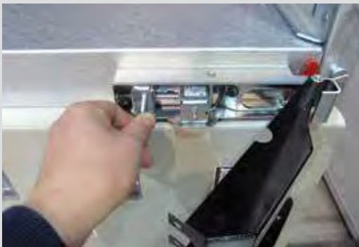
Рис. 2.34. Порядок деактивация блокировки Y81 (шаг 2)
