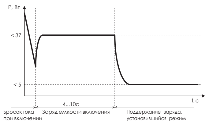
Рис.3.3. График потребления TER_CM_16_Type(220_Par2) при питании от постоянного оперативного тока
