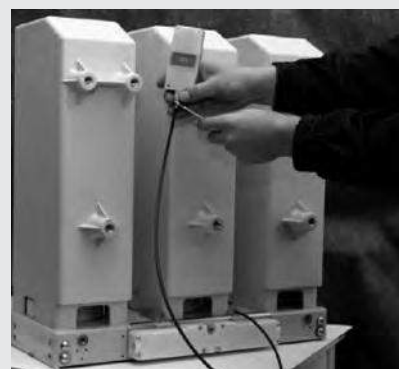
Рис. 50. Регулировка положение индикатора в окошке
