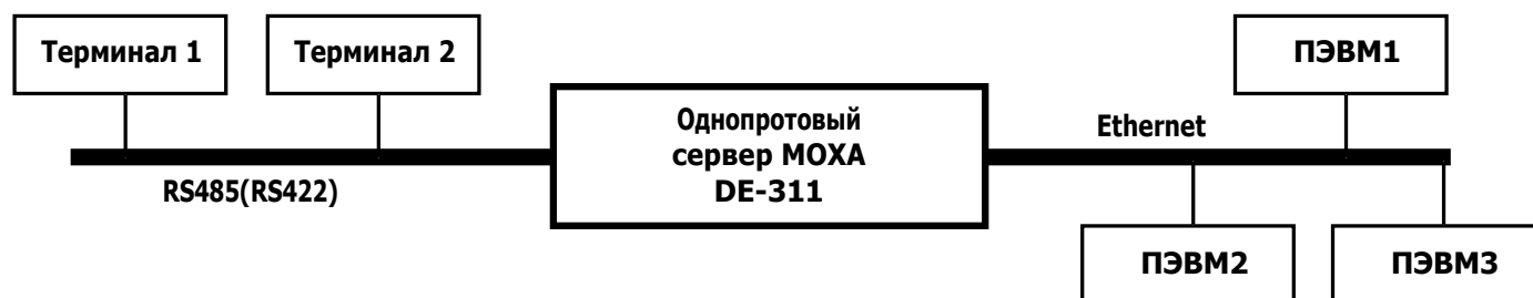
Рис. 7.7. Схема подключения к сети терминалов через сервер (MOXA DE-311)
