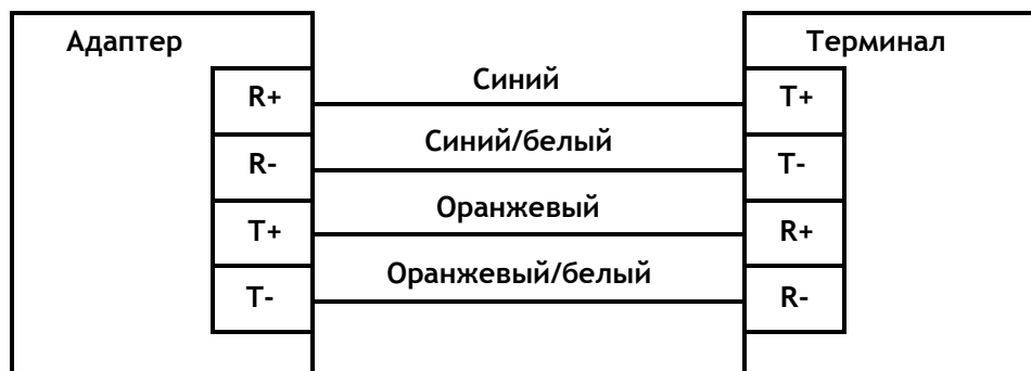
Рис. 7.1. Схема подключения адаптера к терминалу
